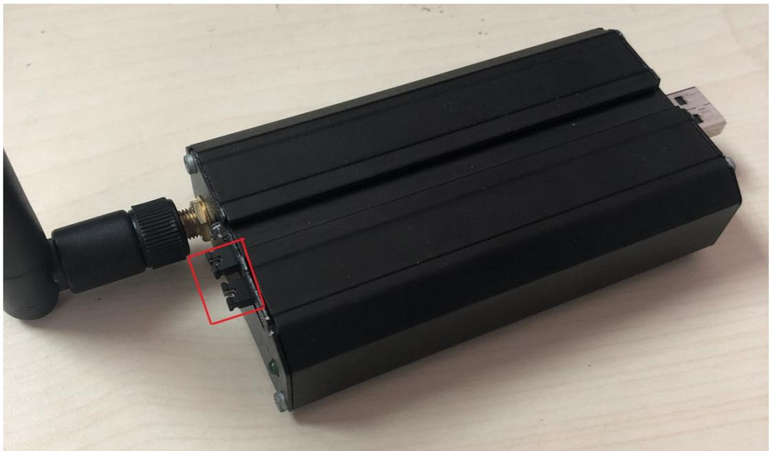
取下跳线帽（红色框中，两个都取下）。单击【检测设备】。即可看到检测到的 LoRa 设备。如下图所示：
