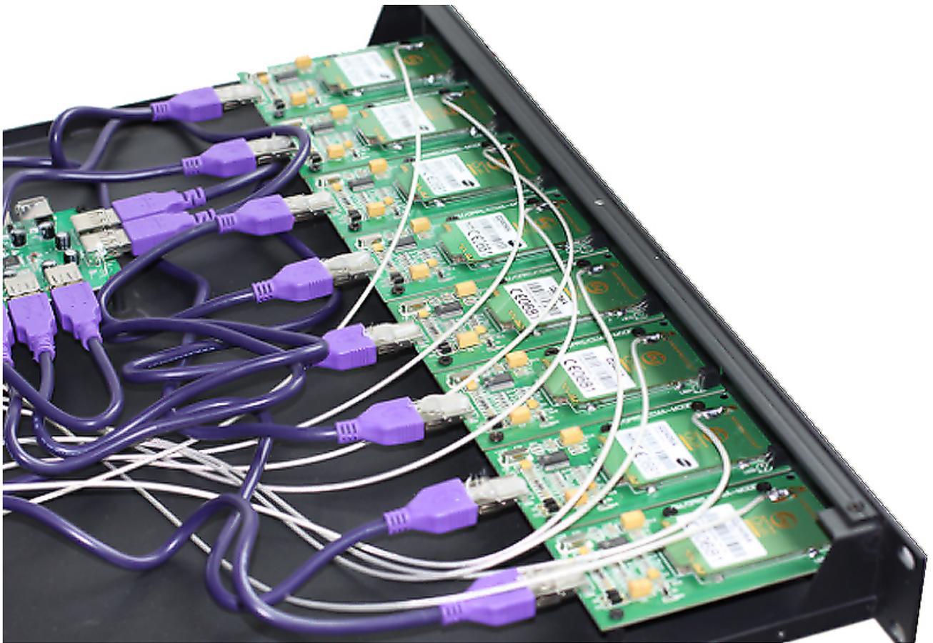
USB信号线一般有密实的屏蔽层，主要是为了防止信号干扰。山寨USB短信猫池内部使用了类似PCI插槽，实现USB信号一拖八串联，采用这种插槽，接触点裸露在空气中，在USB高速数据传输时很容易受到干扰。
