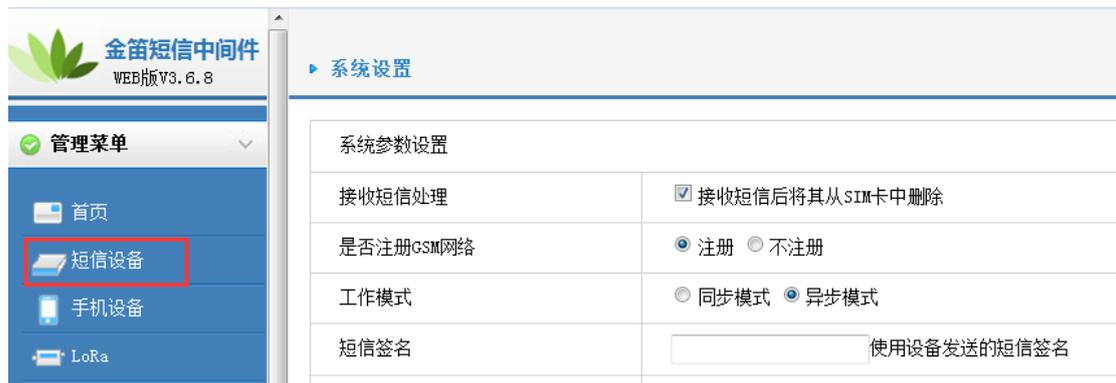
3、进入短信设备列表，如图点击 **检测设备**，等设备检测出来以后勾选要使用的设备，再点击 **启用设备**，此时设备状态是启动就可以进行收发短信测试了，最多可以测试 88 条短信息，如果是正式使用的话需要点击最右侧的 **未授权** 进行注册。
