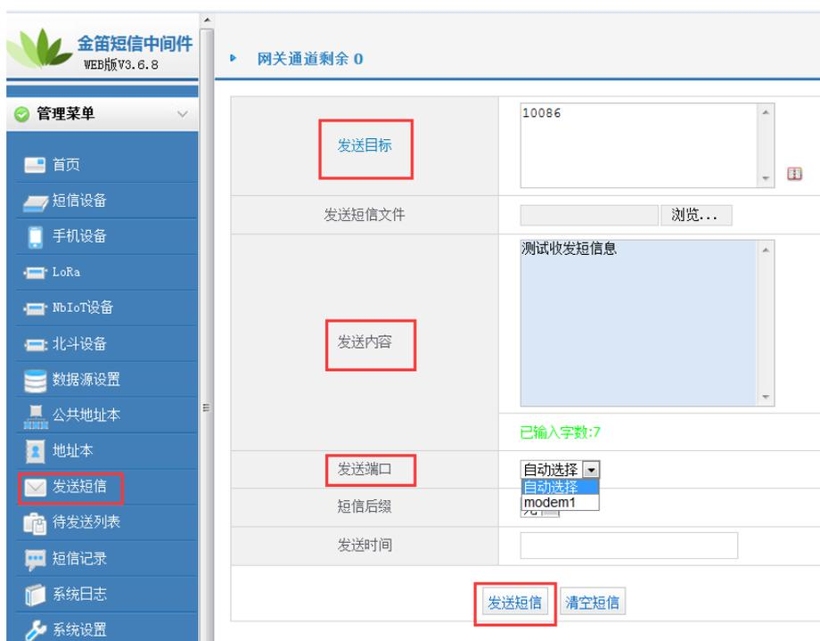
如图在发送目标里填写接收信息的手机号码，在发送内容里填写要发送的短信内容，如果多台设备同时使用，可以在**发送端口**处选择发送信息设备的端口号，也可以使用自动选择方式，然后点击 **发送短信**。
